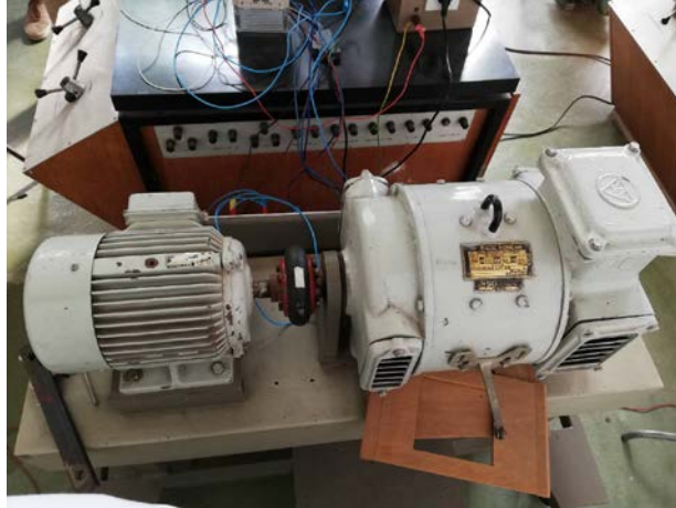
Slika 3. Asinhroni motor spojen osovinom sa motorom jednosmjerne struje
